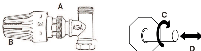
Figuren visar en ventiltermostat av typen NVR för konventionella radiatorer.
